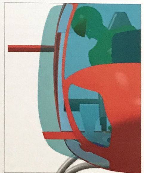
Ein Teil des Kabinenbodens wird herausgeschnitten und durch das neue, verglaste Bauteil ersetzt. Anders als bei einem herkömmlichen Bubble Door ermöglicht das dem Piloten ohne grosse Verrenkungen vertikale Sichtreferenz.
